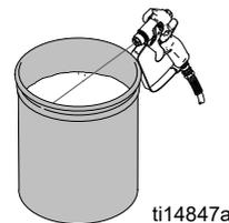
7. 将填料阀旋转至泄流位置以循环冲洗流体，直到出现洁净的冲洗流体。
