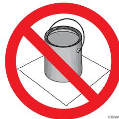
**始终让金属桶接地：**给桶连接接地线。将一端固定在桶上，将另一端固定在真正的接地面，例如水管。
