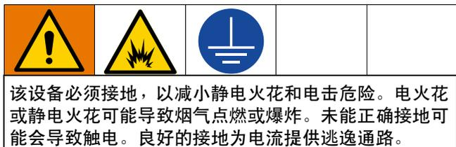
本喷涂机所配电源线具有接地线以及相应的接地插头。
