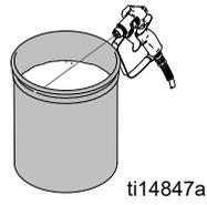
9. 将吸料管提升到冲洗液的液面之上，开动喷涂机 15 至 30 秒钟以将流体排干。关闭泵开关和发动机
