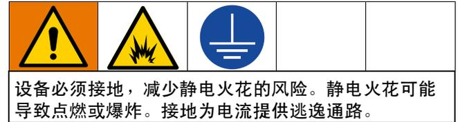
设备必须接地，减少静电火花的风险。静电火花可能导致点燃或爆炸。接地为电流提供逃逸通路。
